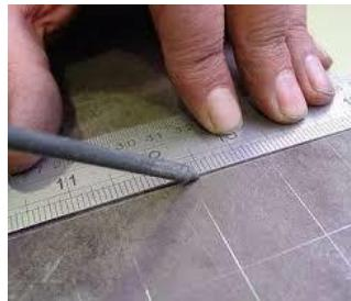
**GUIAS** Las guías son utensilios que se utilizan para guiar o dirigir los útiles de trazado (sirviendo de apoyo o de guía), colocándolas sobre la superficie de la pieza que vamos a trazar. Las más utilizadas son: las reglas, las escuadras y el trasportador de ángulos.
